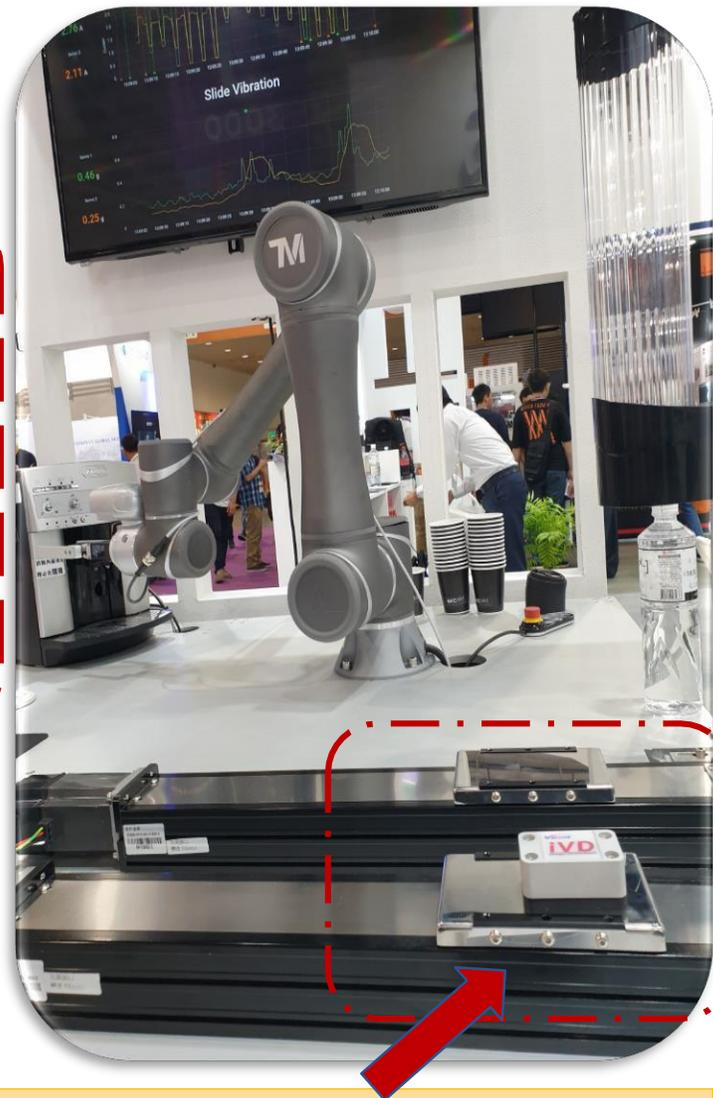
無線方式直接裝載於線性滑軌之滑台，於任意點皆可直接量測各區域之震動值。
